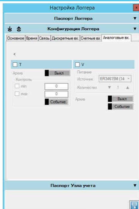
Т – встроенный датчик температуры, В – остаточная емкость батареи или аккумулятора
