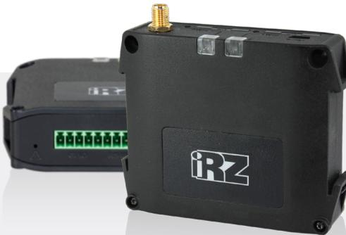
Беспроводной GSM/GPRS-модем iRZ ATMx-485 — готовое программно-аппаратное решение для организации каналов связи с удалёнными объектами в различных режимах — 3G, GPRS, CSD. Модемы могут работать по протоколу TCP/IP в режимах «КЛИЕНТ»/«СЕРВЕР». Ключевая особенность модемов — возможность работы с обычными сим-картами, имеющими динамический IP-адрес.
