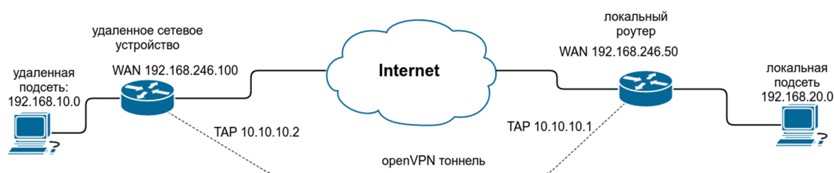
Рис. 9. Примеры конфигураций OpenVPN. Схема сети
